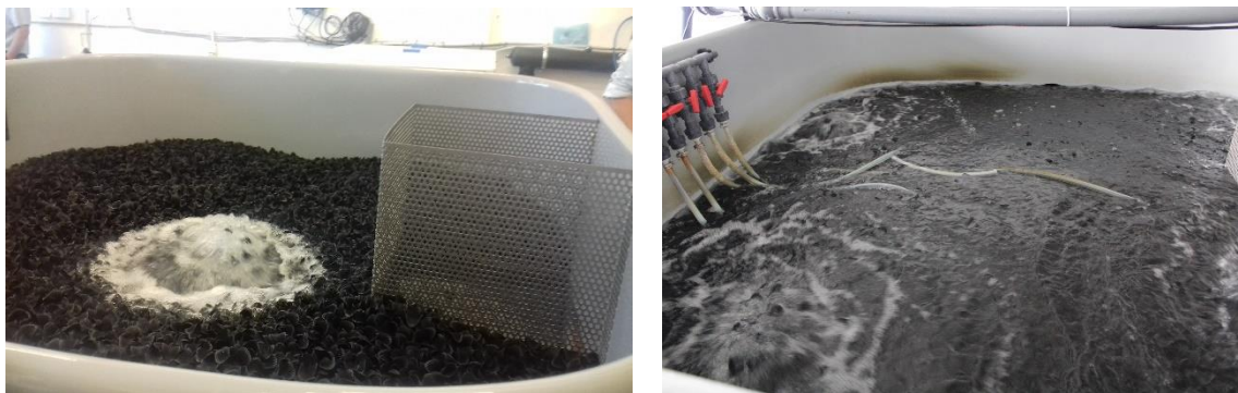
Rysunek 6. Filtracja biologiczna - złożo pływające i złożo nieruchome
