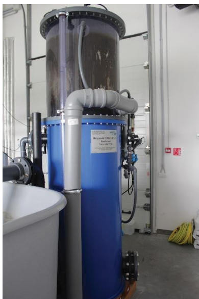
Rysunek 9. Odpieniacz w farmie pilotażowej krewetek w Kłajpedzie projektu InnoAquaTech Zdjęcie: T.Kulikowski/MIR-PIB
