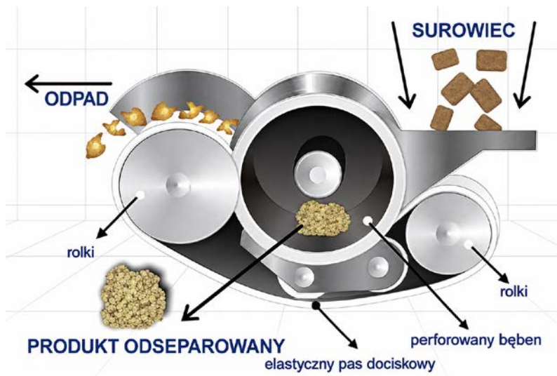
Rys. 16. Schemat separacji ciśnieniowej (wg https://www.sepamatic.de/en/products )
