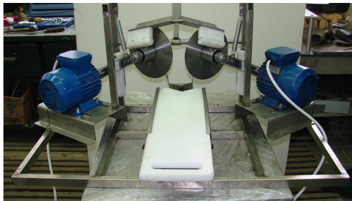
Rys. 5.23. Model I urządzenia odgławiającego cięciem V dwoma nożami, z przemieszczaniem noży względem ryby
