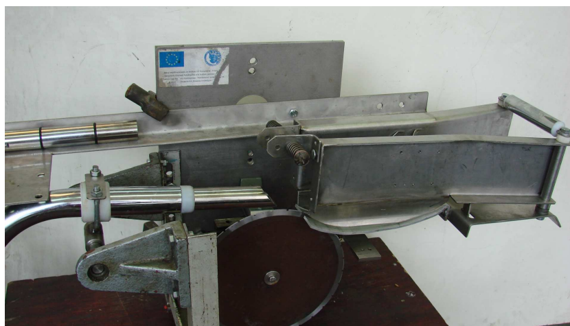
Rys. 5.36. Stanowisko do patroszenia
