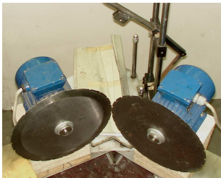
Rys. 5.24. Model II urządzenia odgławiającego cięciem V dwoma nożami, z przemieszczaniem ryby względem noży - załadunek ryby do niecki pod nożami
