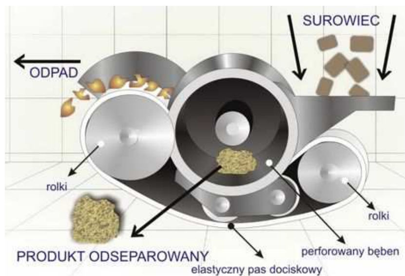
Rys. 5.79. Budowa i schemat działania separatora bębnowego
