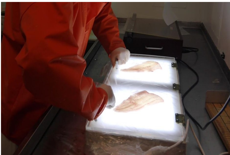
Fot. 9. Badanie tkanki mięśniowej ryb z użyciem podświetlanego kompresora badanie na statku (fot. K. Nadolna - Altn).
