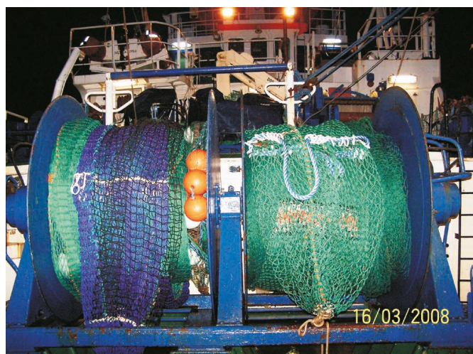
Fot. 1. Denny włók dorszowy z „oknem Bacoma” (oczka kwadratowe w panelu selektywnym) w worku włoka (cz. lewa na fot. z lewej) oraz z oczkami obróconymi o 90° (T90) w worku włoka (cz. prawa na fot. z lewej) oraz tkanina sieciowa typu T90 (fot. z prawej, wg W. Moderhaka).
