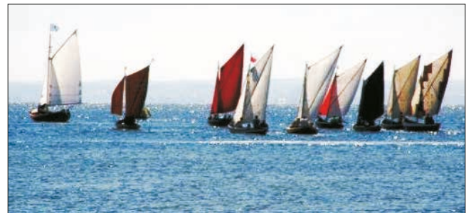
Pomeranka (j. kasz. pómarenk, pómorenk) – żaglowo-wiosłowa, płaskodenna, drewniana łódź rybacka, o długości 8,5-9,0 m; w latach 1880-1930 popularna na Pomorzu Gdańskim do połowów, m.in. storni, szprotów i łososi w odległości do 20 mil od brzegu; Zdjęcie z lewej – eksponat w Muzeum Rybołówstwa w Helu (wg By MOs810 – Praca własna, CC BY-SA 4.0) oraz współczesne repliki ww. łodzi (zdjęcie z prawej), za: https://commons.wikimedia.org/w/index.php?curid=66874504 ; https://pl.wikipedia.org/wiki/Pomeranka ; dostęp 20.03.2019; https://pl-pl.facebook.com/pg/Pomeranki/photos/?ref=page_internal .
