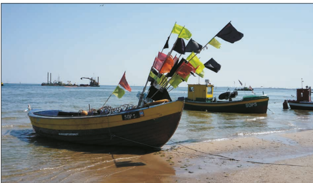
Współczesne bezpokładowe łodzie motorowe (cumujące w Sopocie), stosowane w rybołówstwie przybrzeżnym (z lewej; fot. W. Grygiel) oraz pełnopokładowy kuter rufowiec, stosowany do połowów ryb w wodach otwartych Bałtyku (zdjęcie z prawej).
