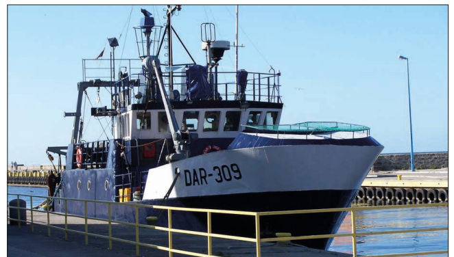
Współczesne bezpokładowe łodzie motorowe (cumujące w Sopocie), stosowane w rybołówstwie przybrzeżnym (z lewej; fot. W. Grygiel) oraz pełnopokładowy kuter rufowiec, stosowany do połowów ryb w wodach otwartych Bałtyku (zdjęcie z prawej).
