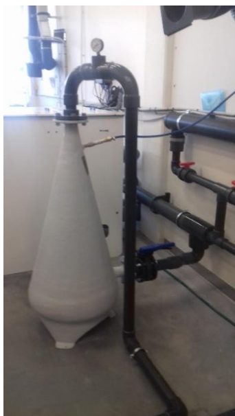
Rysunek 8. Stożek do natleniania w farmie pilotażowej krewetek w Kłajpedzie projektu InnoAquaTech Zdjęcie: T.Kulikowski/MIR-PIB
