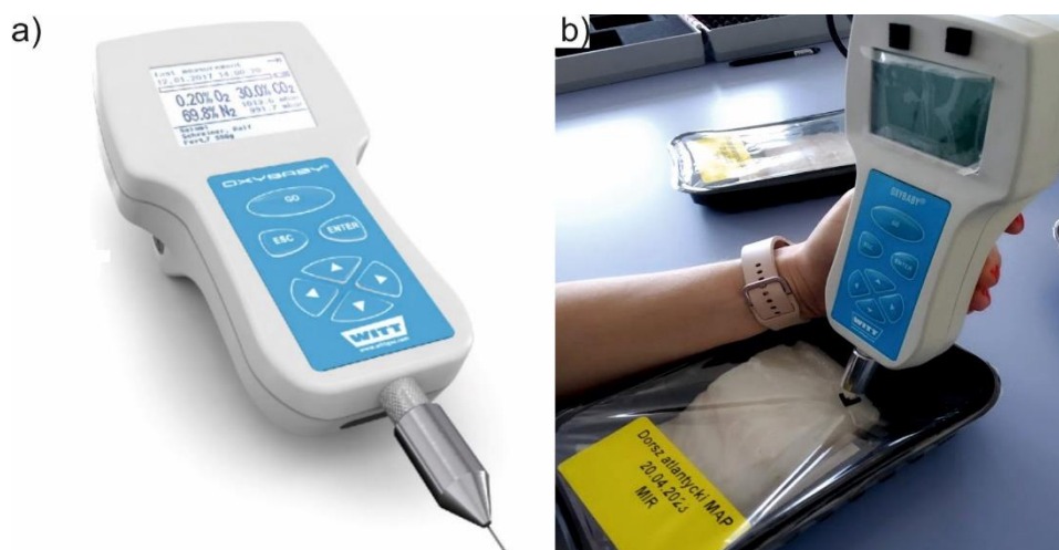
Rys. 13. Mobilny analizator gazów OXYBABY firmy Witt: a) widok ogólny, b) widok w trakcie pomiaru
