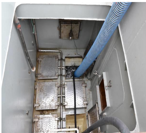
Fot. 23. Wyładunek ryb z ładowni kutra za pomocą systemu hydraulicznego (fot. MIR-PIB)
