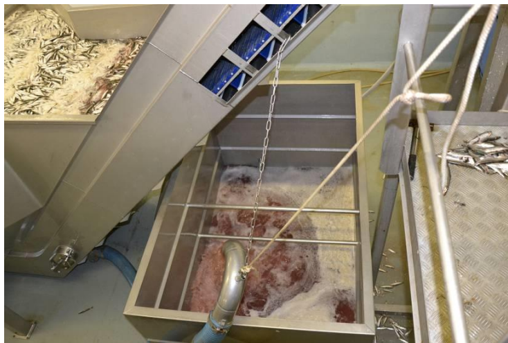
Fot. 20. Zbiornik zużytej wody technologicznej w sortowni na nabrzeżu (fot. MIR-PIB)
