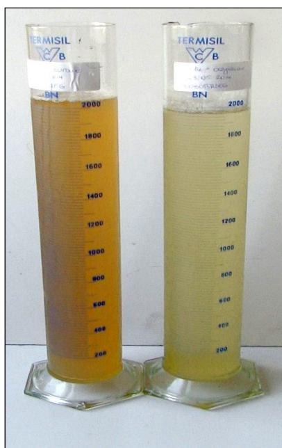
Fot. 30. Próbkę wody z rozładunku pompowego przed (z lewej) i po wstępnym oczyszczeniu (z prawej)
