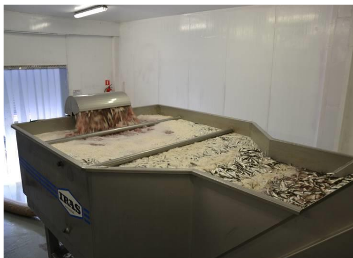
Fot. 5. Zbiornik z przenośnikiem do oddzielenia ryb od wody technologicznej (fot. MIR-PIB)
