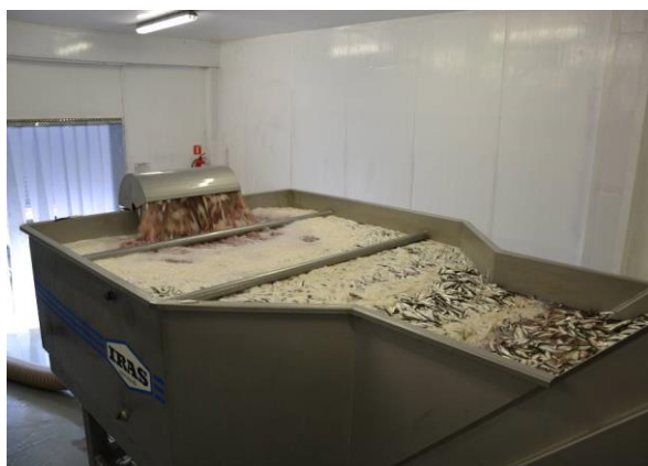
Fot. 19. Transport mieszaniny ryb i wody do zbiornika z przenośnikiem w sortowni (fot. MIR-PIB)
