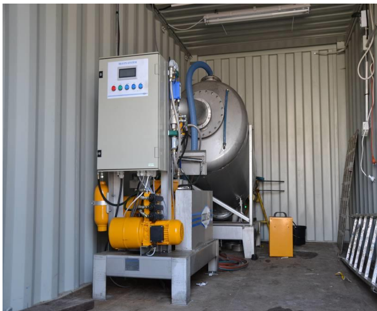
Fot. 22. Instalacja pompowa firmy IRAS (Dania) do wyładunku ryb (fot. MIR-PIB)
