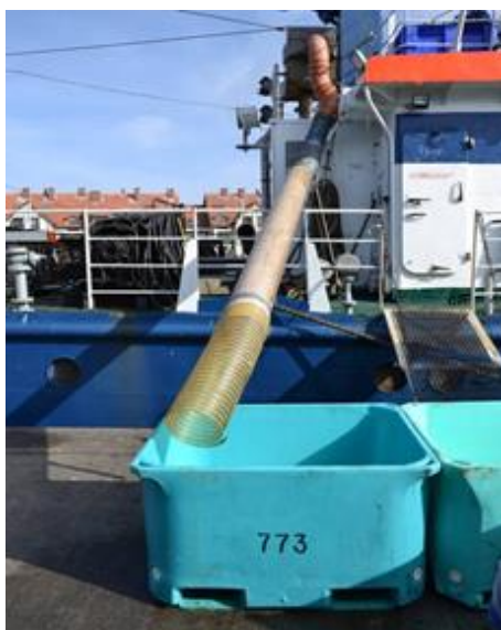
Fot. 24. Przewód do transportu ryb do pojemników big-box (fot. MIR-PIB)
