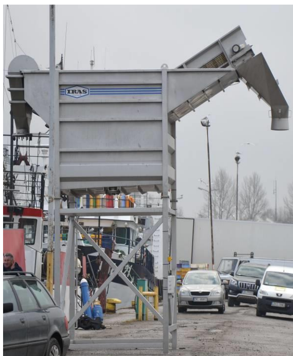
Fot. 17. Instalacja firmy IRAS do hydraulicznego wyładunku ryb (fot. MIR-PIB)
