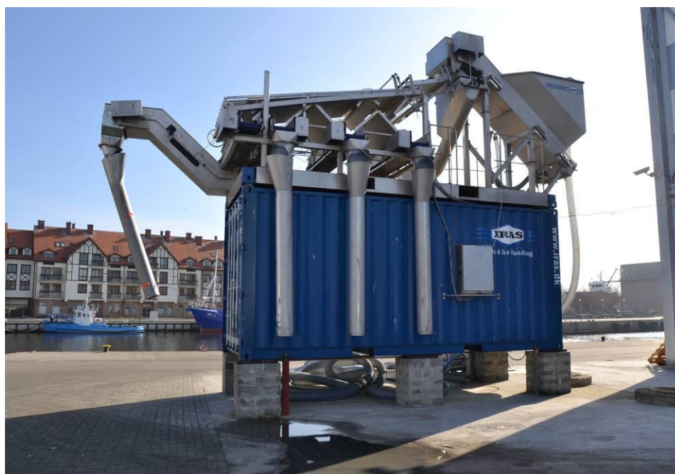
Fot. 21. Instalacja firmy IRAS (Dania) do hydraulicznego wyładunku ryb (fot. MIR-PIB)
