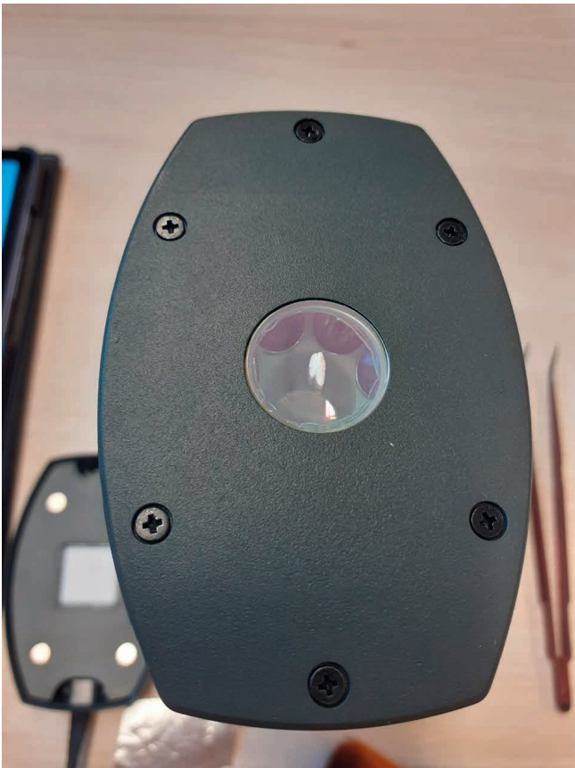
Pomiar widma otolithu śledzia skaner NIR
