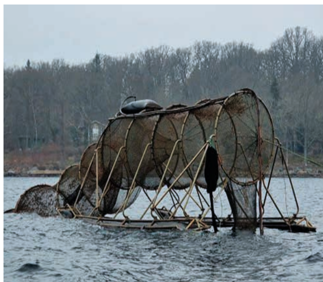
Fot. 6. Uszławniona pływakami klatka „ponton-trap” w Ronneby (fot. Tomasz Wandzel)
