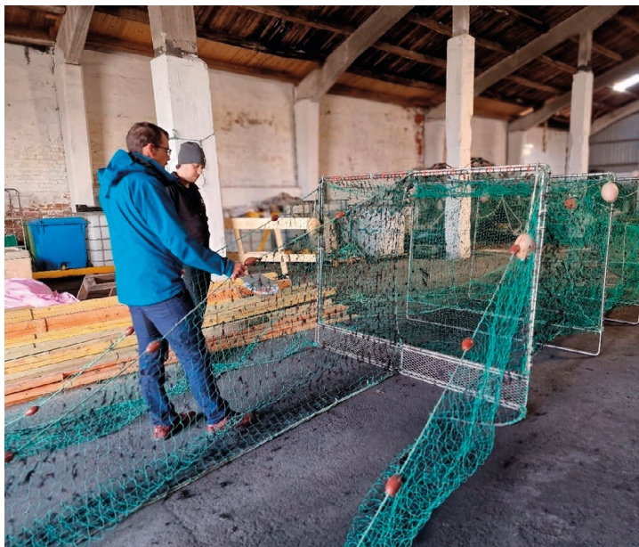
Fot. 9. Wejście do pierwszej komory żaka pontonowego. Najczęściej to w tym miejscu instaluje się kratę uniemożliwiającą fokom wpłynięcie do siatki (fot. Tomasz Wandzel)
