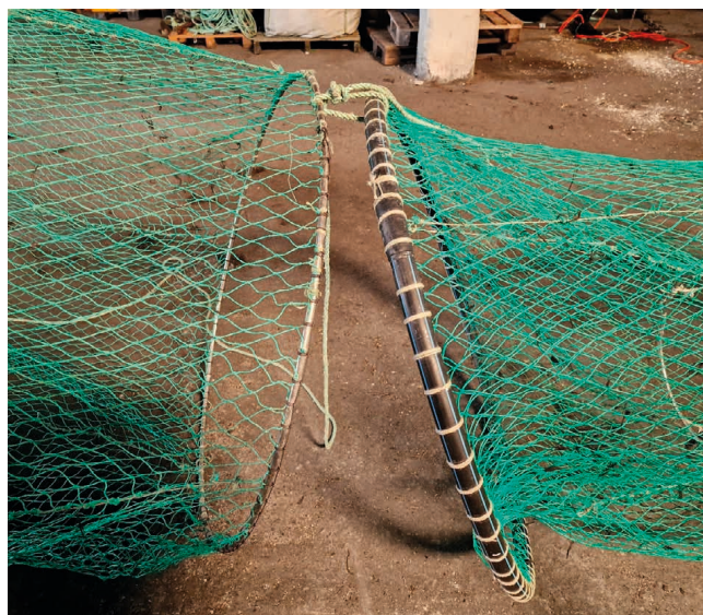
Fot. 10. W niektórych narzędziach szwedzcy naukowcy zastosowali systemy modułowe – mające zapewnić łatwość łączenia poszczególnych elementów pułapek oraz szybki ich demontaż i co za tym idzie – łatwiejszy transport i składowanie (fot. Tomasz Wandzel)
