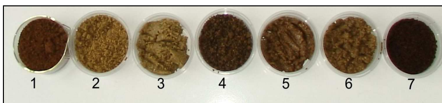
Rys. 26. Próbkę mączek wytworzonych w warunkach laboratoryjnych z: 1 - wnętrzości, 2 - rozdrobnionych wstępnie kręgosłupów, 3 - całych kręgosłupów, 4 - rozdrobnionych wstępnie głów, 5 - całych głów, 6 - płatów brzusznych z płetwami, 7 - rozdrobnionych odpadów mieszanych
