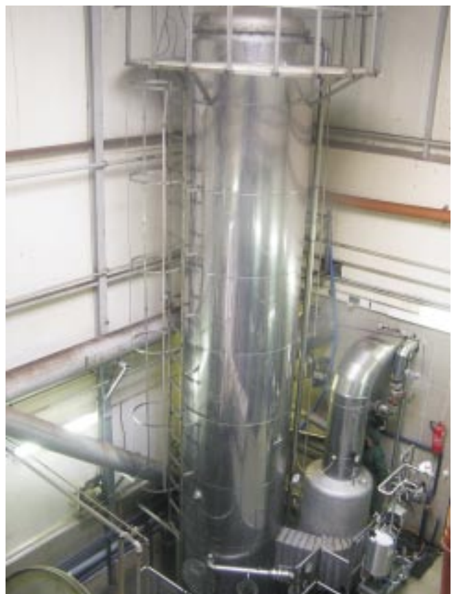
Fot. 2. Kolumnowa wyparka próżniowa do zagęszczania substancji białkowych zawartych w odtłuszczonych wodach produkcyjnych
