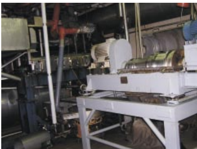
Fot. 1. Dekanter do oddzielania zawieszin stałych z wód produkcyjnych
