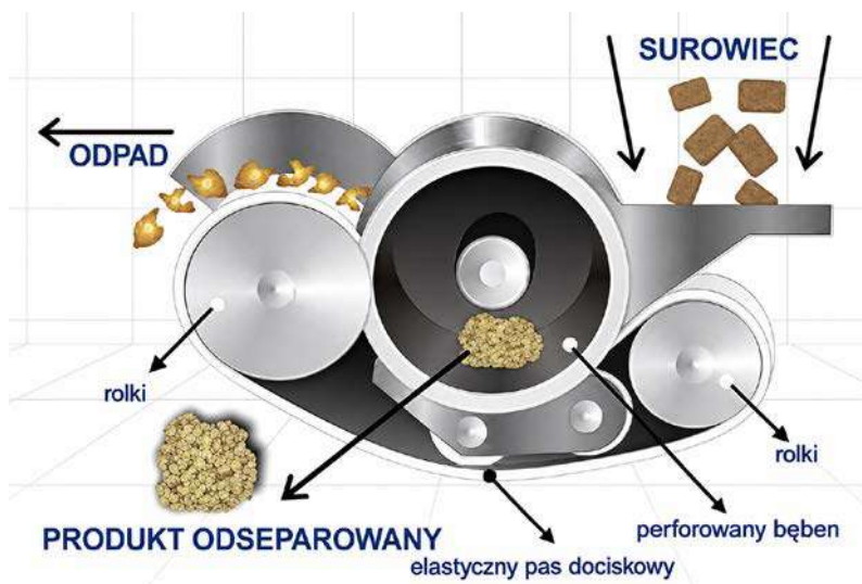
Rys. 16. Schemat separacji ciśnieniowej (wg https://www.sepamatic.de/en/products )
