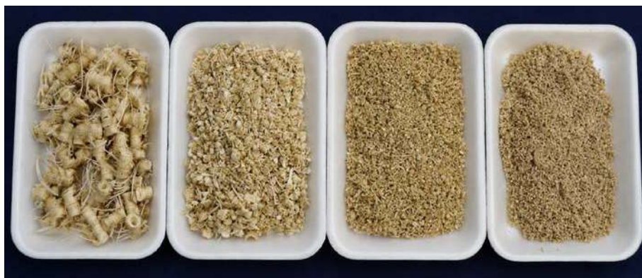
Rys. 61. Rezultaty trójstopniowego rozdrobnienia kości z kręgosłupów łososi w udarowo-ciernym młynku (fot. MIR-PIB)
